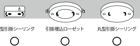
●上面のシーリングボディがついていない場合は、専門の電気工事店へご依頼してください。シーリングボディの取付け電気工事の際は充分な長さの取付けネジ2本で天井の補強材のある位置に取付けてください。
