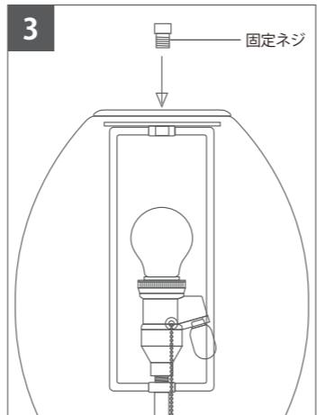
シェード上部の金具に固定ネジを回し入れて下さい。
