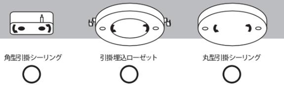
●上面のシーリングボディがついていない場合は、専門の電気工事店へご依頼してください。シーリングボディの取付け電気工事の際は十分な長さの取付けネジ 2 本で天井の補強材のある位置に取付けてください。
