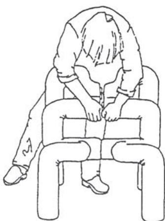
Montering av øverste del av ryggbeslaget, skjer ved at ene halvparten (med tapp) bender bakover, mens den andre (med hull) drar du til deg slik at tappen hekter seg inn i hullet.
