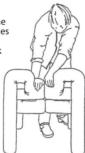
Durch Druck auf die eine Hälfte und auf die andere Hälfte des Rückenteiles, springt die obere Kralle in die richtige Position. (Zug beim Rückenteil mit der Kralle, Druck beim Rückenteil mit dem Gegenstück der Kralle).
