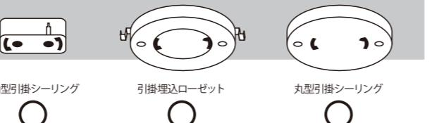
●上面のシーリングボディがついていない場合は、専門の電気工事店へご依頼してください。シーリングボディの取付け電気工事の際は充分な長さの取付けネジ2本で天井の補強材のある位置に取付けてください。
