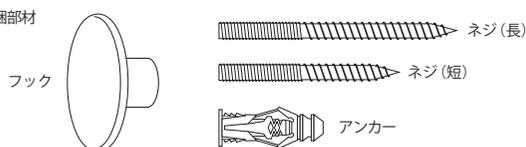
ネジは二種類の長さを同梱しています。壁の厚みに合わせてご使用ください。
