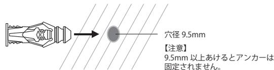
※コンクリート、ALC板、木材などの硬質壁にも使用できますが、その際は下穴を直径10mm程度の大きさにあけて使用してください。
