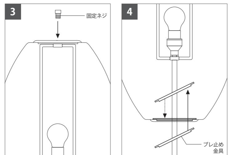
シェード上部の金具に固定ネジを回し入れて下さい。
