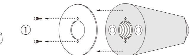
① ピス2本を本体から外し、次にシェード受けプレートを外します。プレートは本体と磁石により固定されていますので外す時はやや強い力が必要です。道具を使って外す場合は本体やプレートを傷つけないように注意ください。
