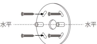
本体との結合部分の水平位置を確認し、取付金具を木ネジ4本でしっかりと壁に固定してください。
