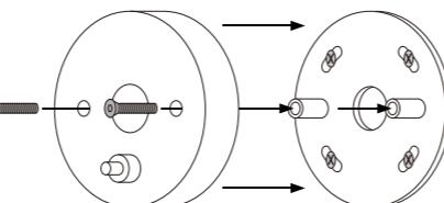
灯体本体をかぶせ付属の六角ビスで壁面に設置した取付金具に固定してください。
