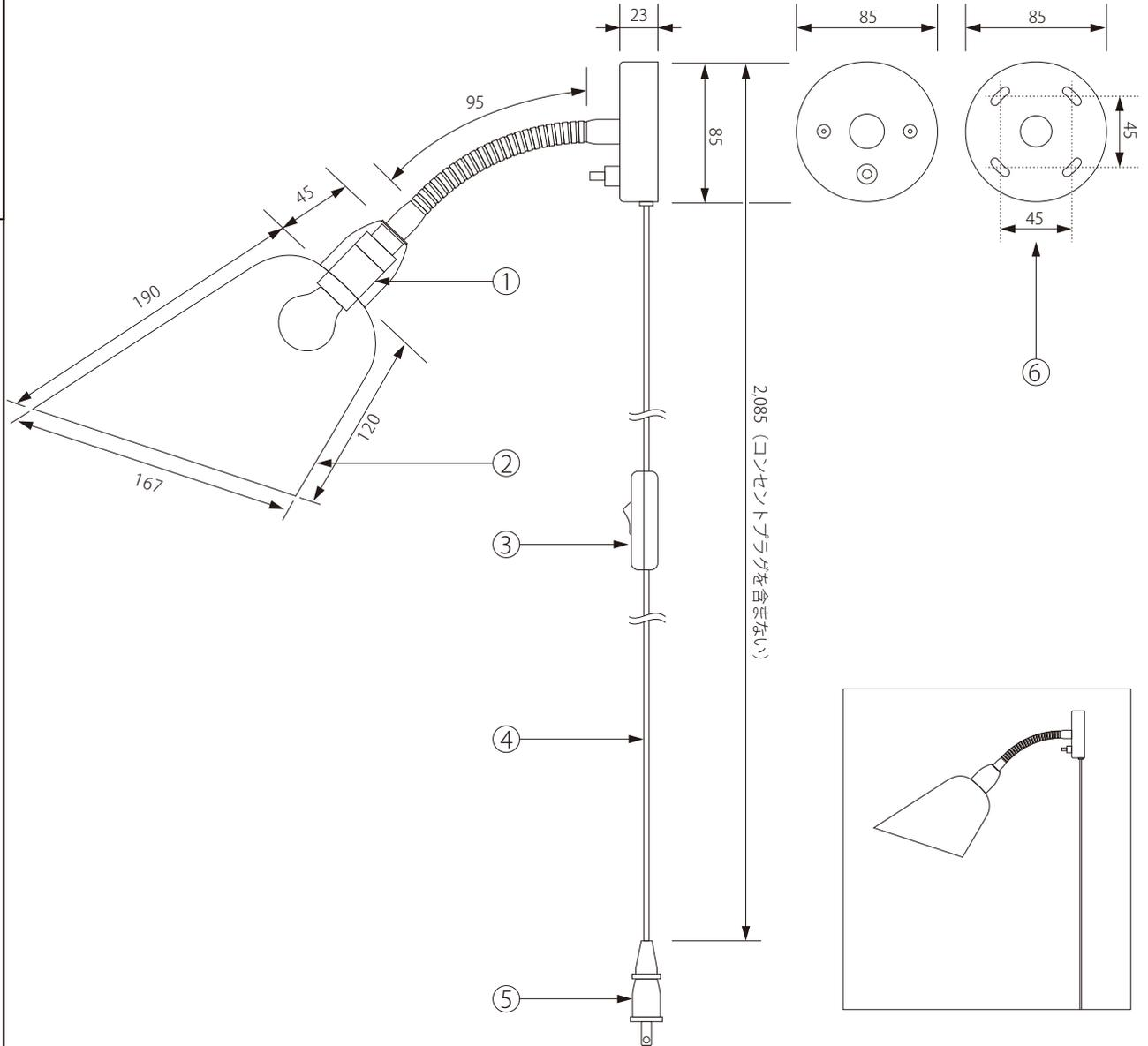
注記) 適合ランプ：口径 E17・ミニクリプトン球 40W
